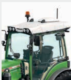
Le récepteur du Fendt Guide est bien protégé et intégré au design du toit.
